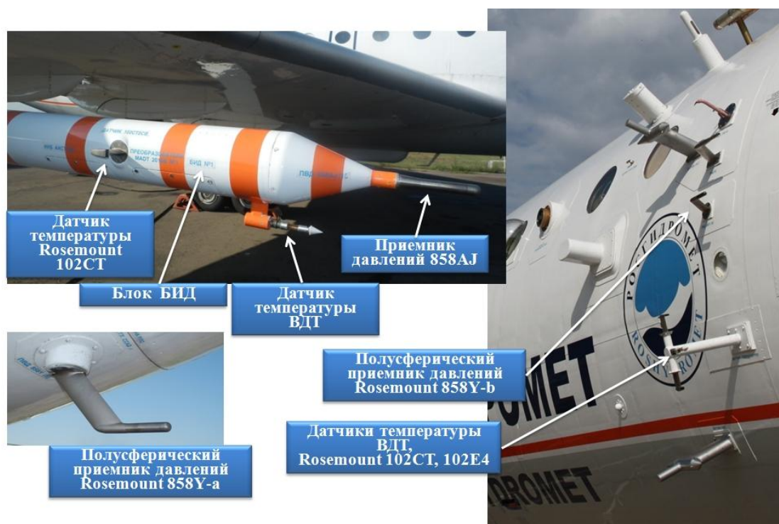
Рисунок 1 — Размещение наружных датчиков АПК-1 на самолёте-лаборатории Як-42Д «Росгидромет»
