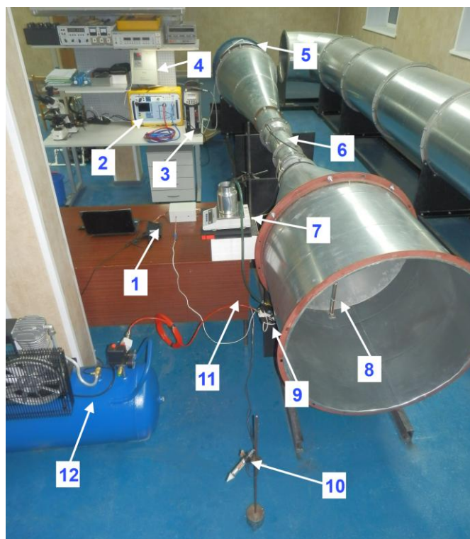
Рисунок 2 — Специальная аэродинамическая установка для исследований самолётных датчиков температуры
